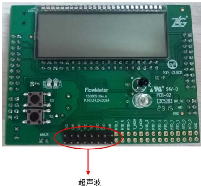
图 2.5 水表超声波接口实物图
